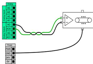
Cet exemple montre comment contrôler une bande de transport avec une entrée de commande de vitesse analogique.
