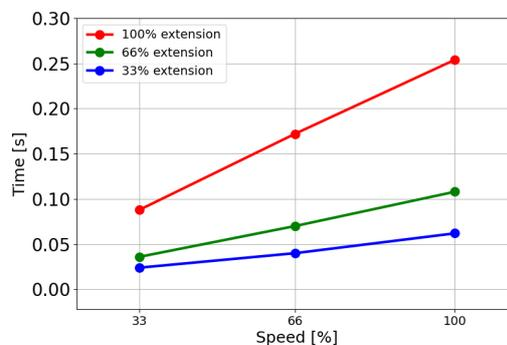
Temps d'arrêt en secondes pour 66 % de 7,5 kg
