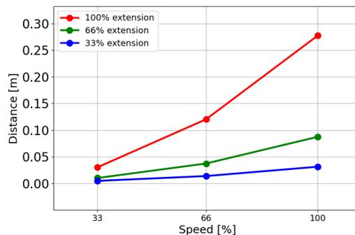
Distance d'arrêt en mètres pour une charge utile maximale de 7,5 kg
