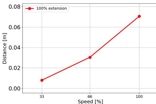
Distance d'arrêt en mètres pour la charge utile maximale de 7,5 kg
