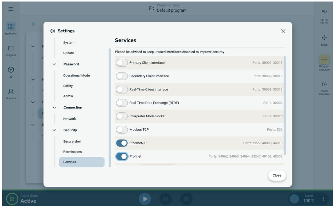
**Utilisation de Profinet** Voici où trouver les fonctions Profinet dans PolyScope X :
