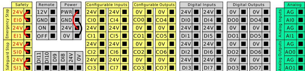
Vous pouvez utiliser le bloc d'entrées numériques horizontales (DI8-DI11), illustré ci-dessous, pour l'encodage en quadrature du suivi du convoyeur.
