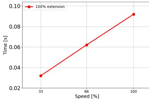
Temps d'arrêt en secondes pour la charge utile maximale de 7,5 kg
