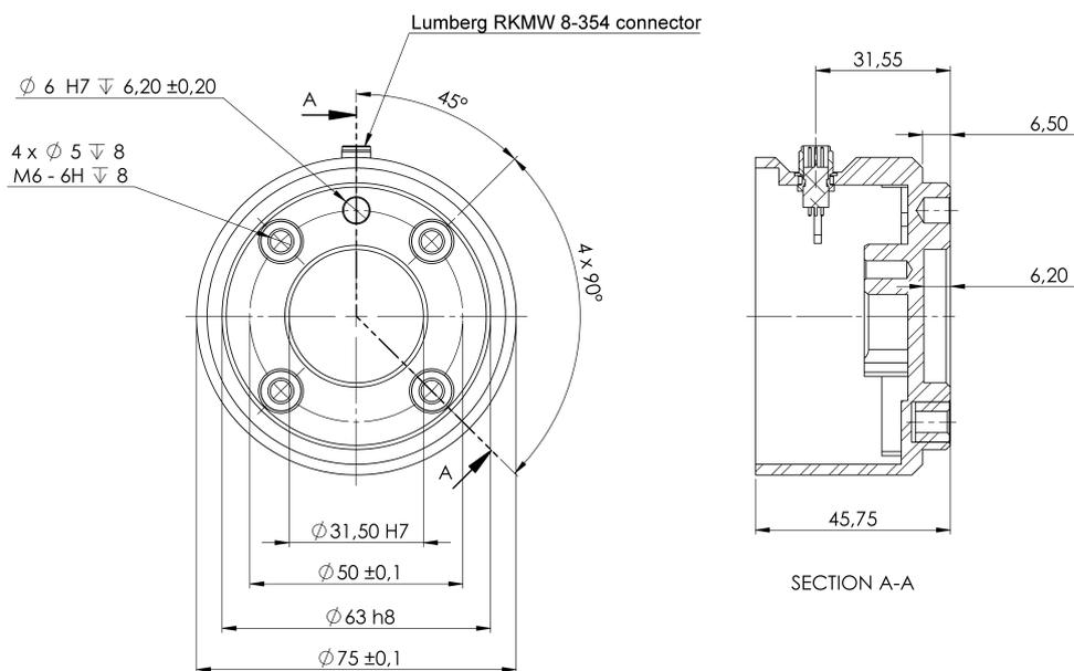
Dimensions et le modèle de trous de la bride de l'outil. Toutes les mesures sont en millimètres.
