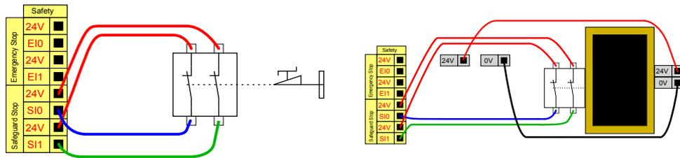
Dans cet exemple, un contacteur de porte est utilisé en tant que dispositif de sécurité de base qui permet d'arrêter le robot à l'ouverture de la porte.
