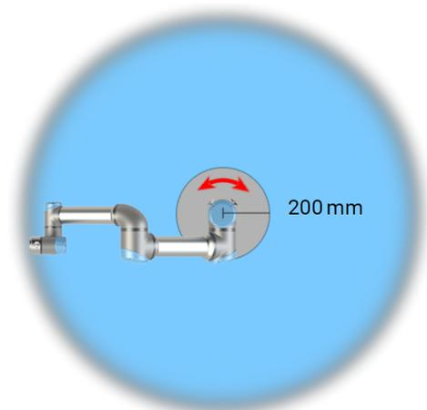
*À cause des propriétés physiques du bras du robot, certaines zones de l'espace de travail nécessitent une attention particulière quant aux risques de pincement. Une zone (à gauche) est définie pour les mouvements radiaux, lorsque l'articulation du poignet 1 est à au moins 750 mm de la base du robot. L'autre zone (à droite) est à 200 mm de la base du robot, lorsqu'il se déplace dans la direction longitudinale.*
